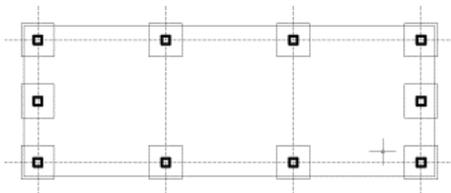
**Étape 1:** Déterminez la position correcte des plots. Les plots en béton doivent être alignés. Vous pouvez le faire en tendant une corde du premier plot au dernier plot.
